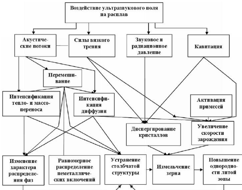
Рис. 2. Схема механизма воздействия ультразвука на процесс кристаллизации и дегазации металла
