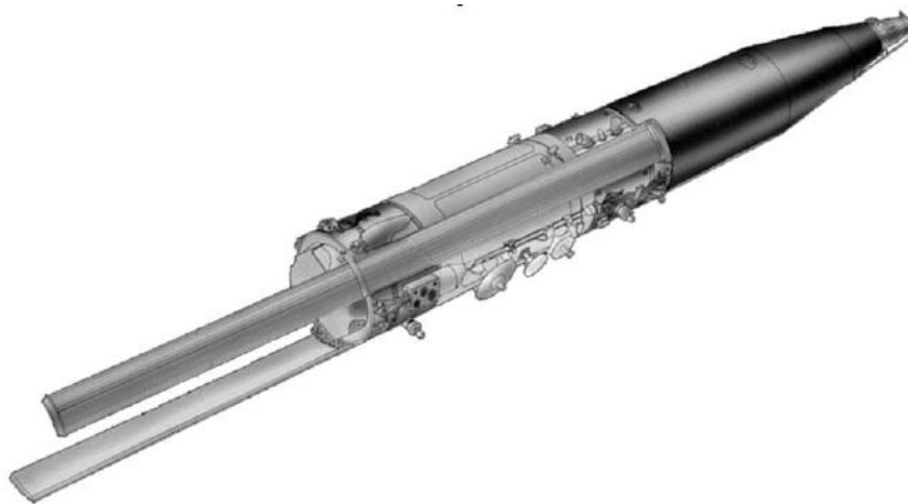
Рис. 4. ЯЭУ БУК совместно с КА двухстороннего радиолокационного обзора УС-АМ системы МКРЦ (после 1985 г.)
