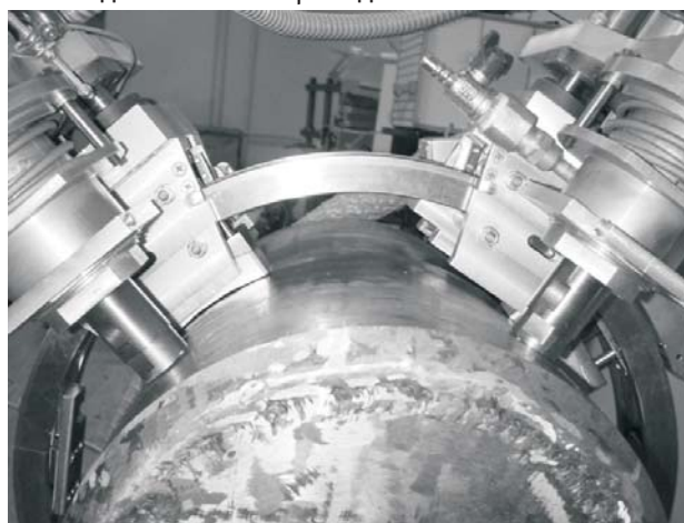
Рис. 3. Механизм устройства ультразвуковой обработки сварных соединений
