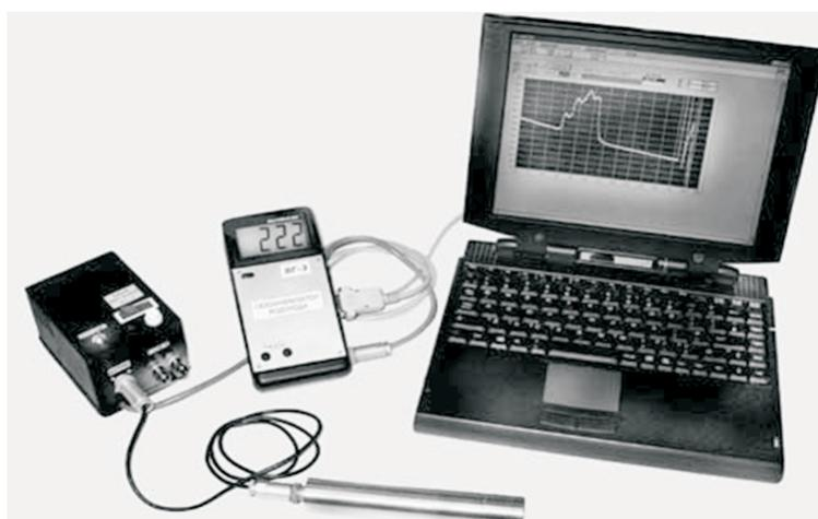
Рис. 1. Водородный газоанализатор ВГ-2А. Разработка НИЯУ МИФИ
