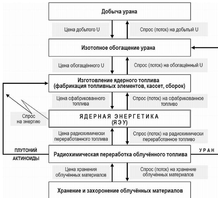
Рис. 1. Итерационная схема Я.В.Шевелёва получения локально-оптимального плана для сложных систем (на примере упрощённой системы ядерного топливно-энергетического комплекса)
