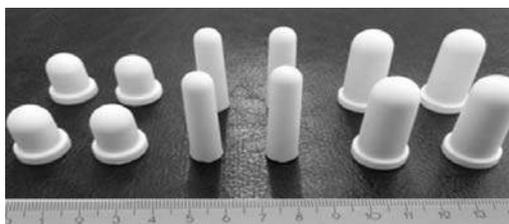
Рис. 3. Керамические чувствительные элементы датчиков контроля ТДА кислорода
