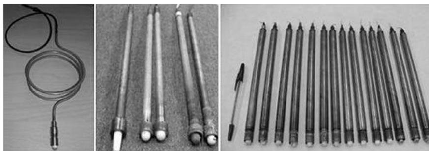
Рис. 4. Образцы датчиков активности кислорода капсульного типа
