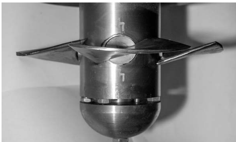
Рис. 5. Узел установки поворотных лопаток НСО-01 НГТУ
