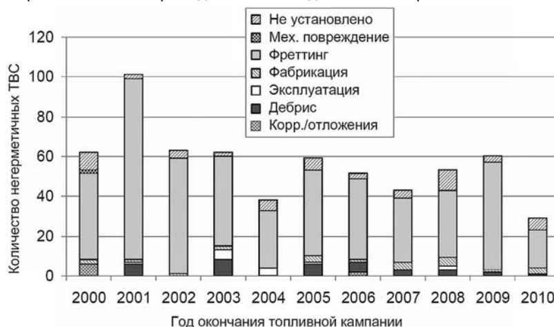
Рис. 7. Количество ежегодно исследованных негерметичных ТВС PWR на АЭС США в период 2000 – 2010 гг. с указанием установленных причин разгерметизации [1]
