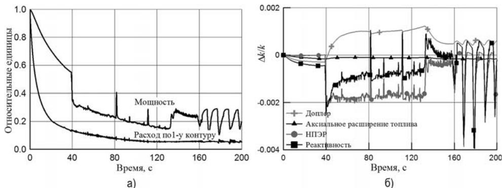
Рис. 7. Изменение параметров реактора в аварии ULOF. Вариант с прослойкой: а) относительная мощность и относительный расход по первому контуру; б) эффекты реактивности
