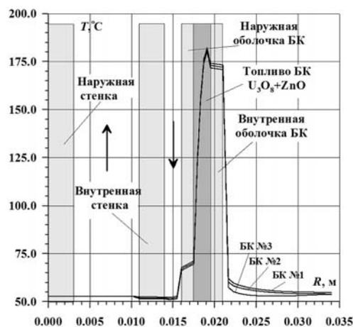
Рис. 8. Распределение температуры по поперечному сечению ЭК с первыми тремя блок-контейнерами на мощности 15 МВт
