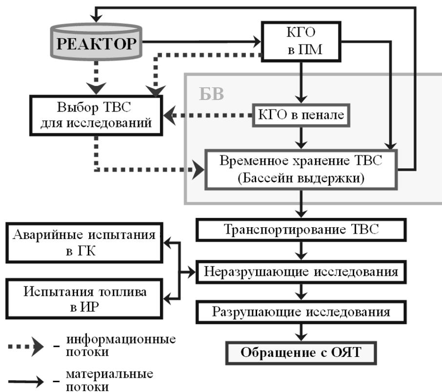
Рис. 2. Традиционная схема послереакторных исследований топлива ВВЭР
