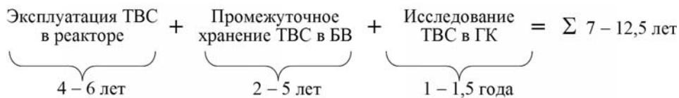
Рис. 3. Временной цикл получения данных о состоянии ТВС после эксплуатации
