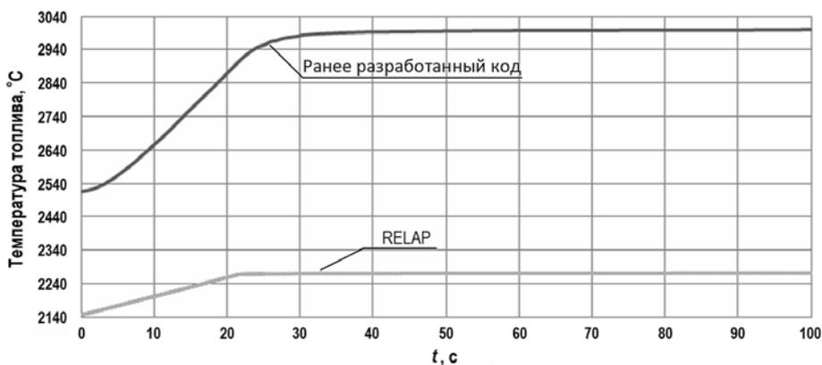
Рис. 3. Поведение температуры топлива при извлечении стержня AP в течение 21,5 с
