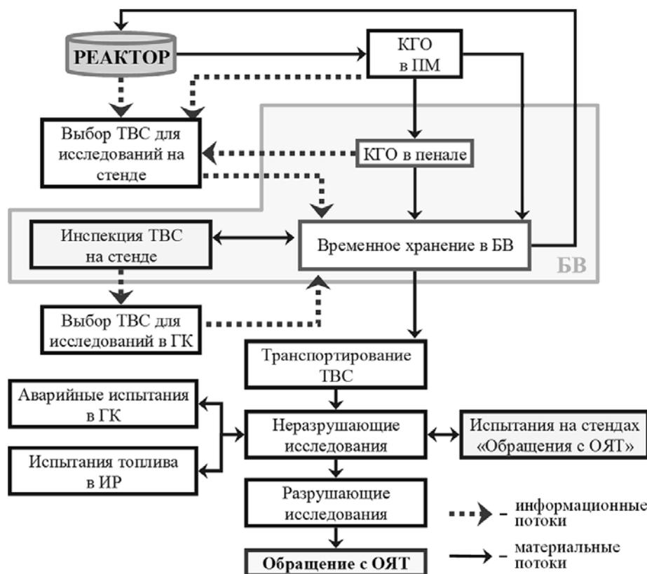
Рис. 4. Модернизированная схема послереакторных исследований топлива ВВЭР
