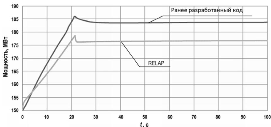
Рис. 2. Поведение мощности при извлечении стержня AP в течение 21,5 с
