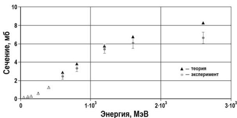
Рис. 1. Теоретические и экспериментальные данные реакции  $^{52}\text{Cr}(p,x)^{7}\text{Be}$
