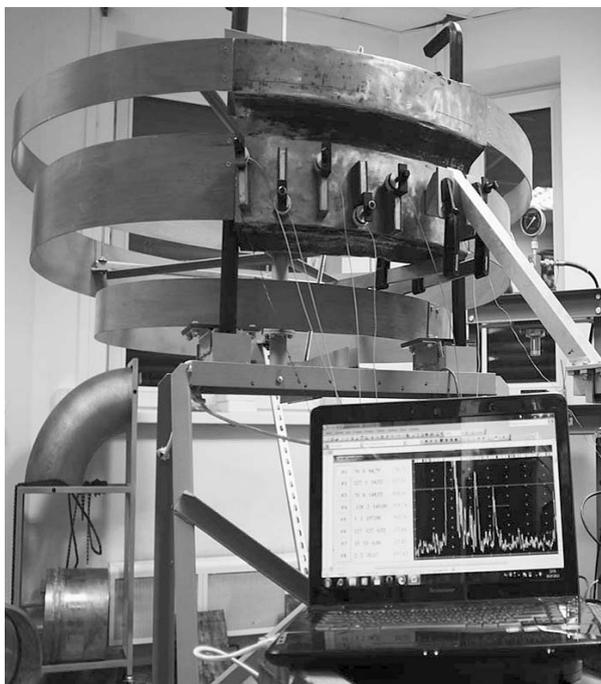
Рис. 2. Полномасштабный стенд для отладки схемы локализации сигналов АЭ в распределенной АЭ-системе на патрубке ПГ
