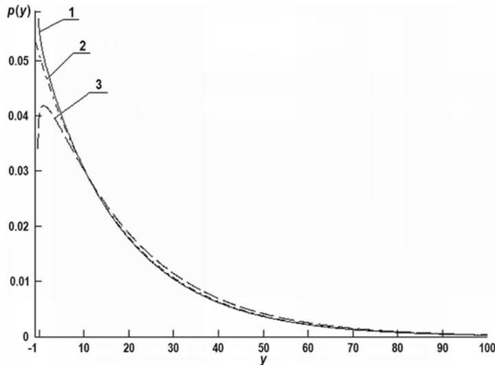
Рис. 1. Плотность распределения  $p(y)$  непрерывного аналога дискретного числа нейтронов в подкритическом реакторе: 1 – интенсивность источника  $S = 0.9145 \cdot 10^3$  н/с; 2 – параметр  $a = 1$ ,  $S = 1 \cdot 10^3$  н/с; 3 – интенсивность источника  $S = 1.1 \cdot 10^3$  н/с
