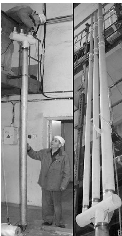
Рис. 11. Тепловая труба для химического реактора (рабочее вещество – калий, диапазон рабочих температур 550–600°C)
