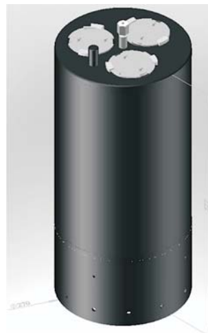
Рис. 10. Термостат технологический с тремя колодцами для загрузки образцов (рабочее вещество – калий, диапазон рабочих температур 350–650°C)
