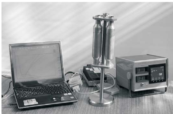
Рис. 5. Система раннего обнаружения и контроля горючих и взрывоопасных газов
