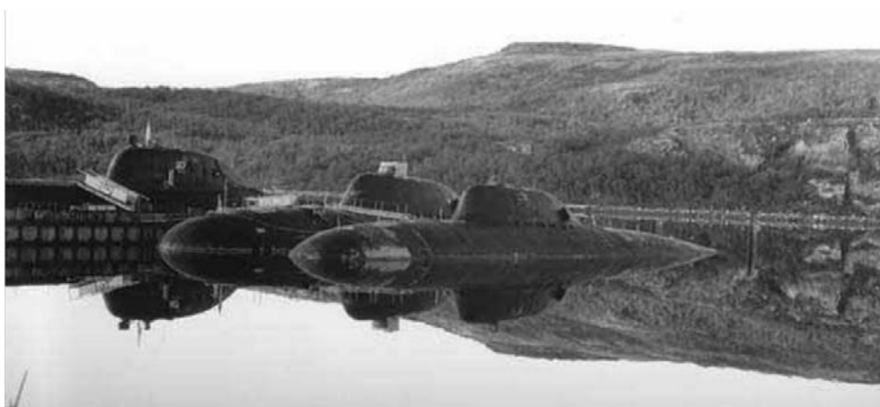
Рис. 2. Атомные подводные лодки (проекты 705 и 705К) с теплоносителем Pb-Bi
