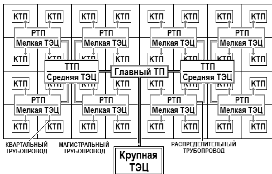
Рис.1. Агрегативная схема подключения тепла от ТЭЦ малой, средней и крупной мощности
