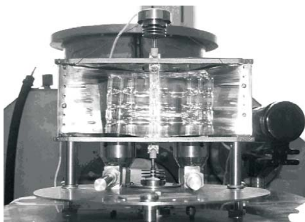
Рис. 1. Экспериментальный участок с параболическим цилиндром
