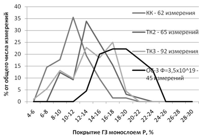
Рис. 5. Концентрация фосфора на поверхностях межзеренного разрушения образцов контрольного, 2-го, 3-го температурных комплектов и лучевого комплекта образцов-свидетелей МШ Калининской АЭС (блок 2)
