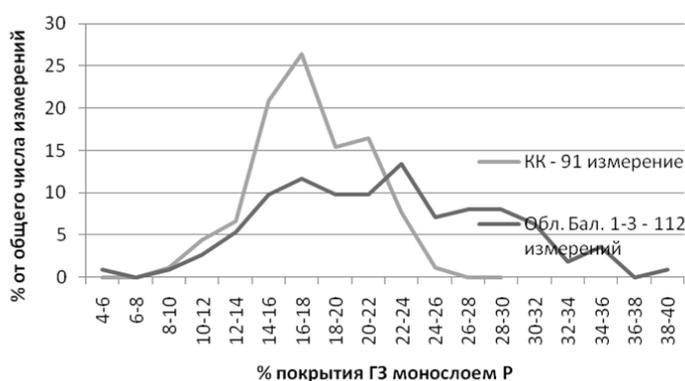
Рис. 6. Концентрация фосфора на поверхностях межзеренного разрушения образцов контрольного и лучевого комплектов образцов-свидетелей МШ Балаковской АЭС (блок 1)
