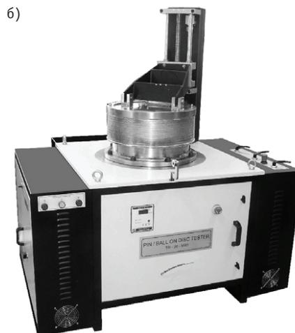
Рис. 4. Стенды для испытаний материалов пар трения в среде гелия: а) – стенд Л-1129; б) – трибометр TR 20 М 40
