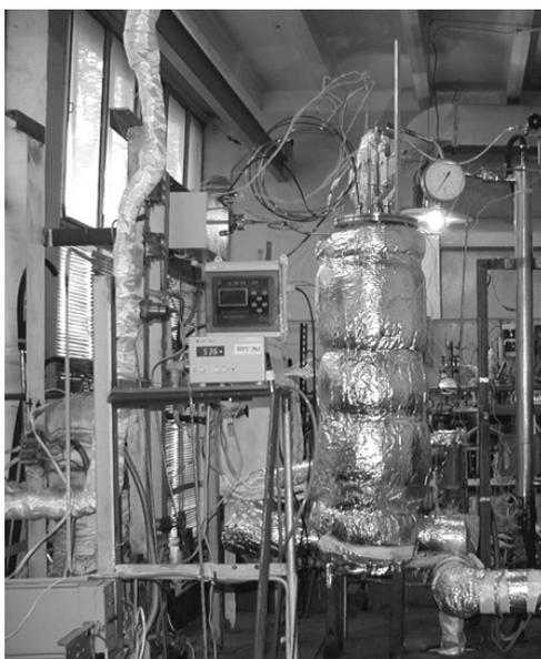
Рис. 1. Макетный образец прямоконтактного испарителя с «принудительной» циркуляцией теплоносителя
