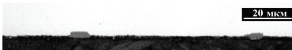
Рис. 6. Микрофотография поперечного сечения полированного образца после оксидирования
