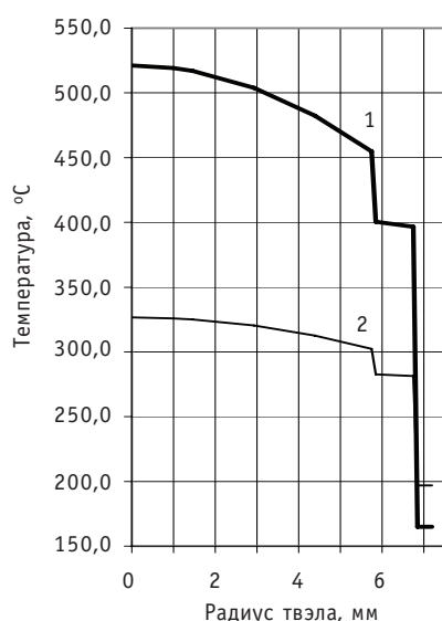
Рис. 9. Распределение температуры по радиусу твэлов во внутреннем модуле АЗ (проектировочный расчет): 1 – твэл с максимальной тепловой мощностью; 2 – твэл со средней тепловой мощностью
