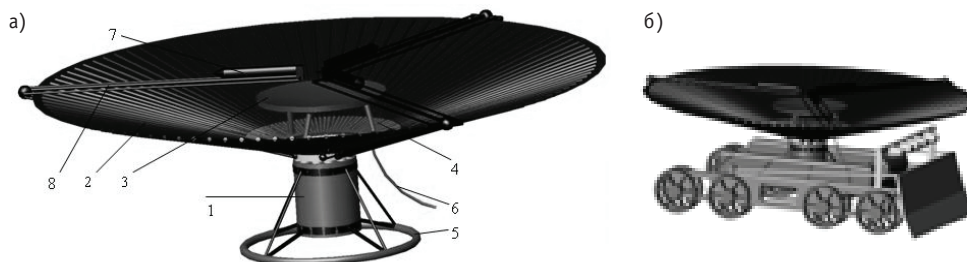
Рис. 1. Внешний вид (а) и схема размещения (б) ЯЭУ SAFE-300-ТЭП на универсальном транспортном средстве: 1 – реактор; 2 – холодильник-излучатель; 3 – балластный излучатель; 4 – ТЭП; 5 – опорное кольцо со стойками; 6 – силовой кабель и жгут телеметрии; 7 – приводы органов регулирования; 8 – штанги тяг приводов
