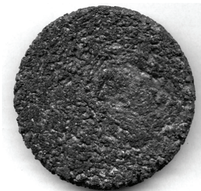
Рис. 2. СВС-продукт (диаметр 55 мм, толщина 7 мм)
