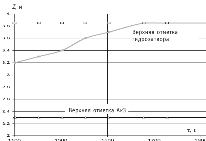
Рис. 7. Динамика уровня теплоносителя в баке при заливе бака реактора системой СПОТ
