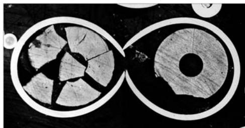
Рис. 5. Характер деформации оболочек рефабрикованного (слева) и свежего (справа) твэлов
