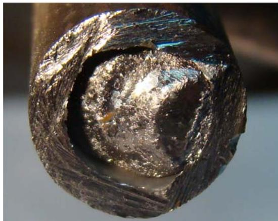
Рис. 2. Внешний вид поверхности застывшего ТЖМТ в зоне отрыва (I серия)
