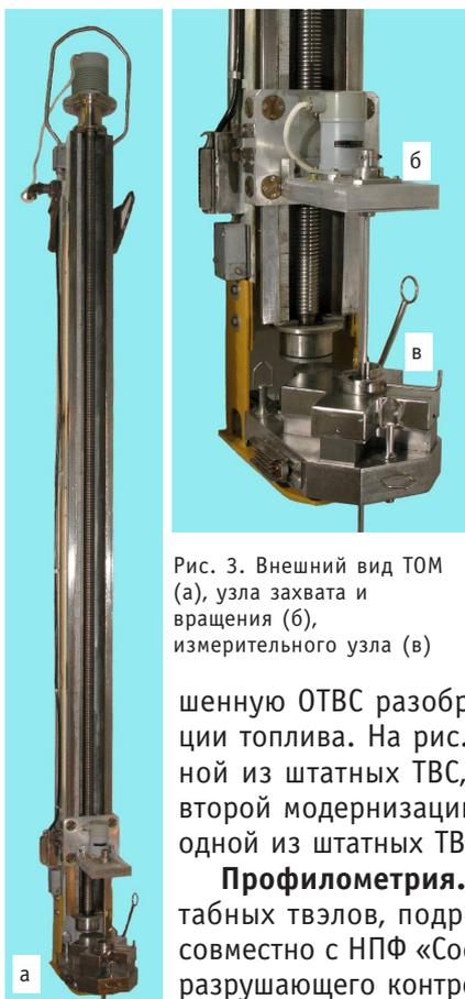
Рис. 3. Внешний вид ТОМ (а), узла захвата и вращения (б), измерительного узла (в)
