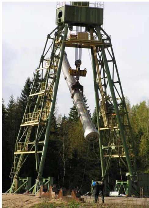
Рис. 1. Бросковые испытания опытного образца ТУК-84
