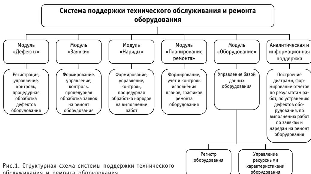
Рис.1. Структурная схема системы поддержки технического обслуживания и ремонта оборудования
