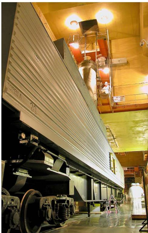
Рис. 2. Вагон-контейнер ТК-84/1 в железнодорожном коридоре блоков №1, 2
