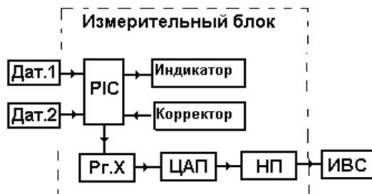
Рис. 2. Структурная схема блока измерения: Дат. 1, Дат. 2 – датчики вращения; PIC – контроллер; Рг.Х – регистр хранения; ЦАП – цифроаналоговый преобразователь; НП – нормирующий преобразователь; ИВС – измерительно-вычислительная система
