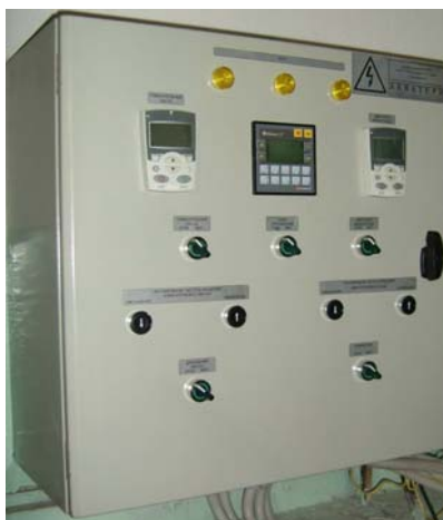
Рис.4. Вид на шкаф с микропроцессорной системой управления экспериментальным стендом
