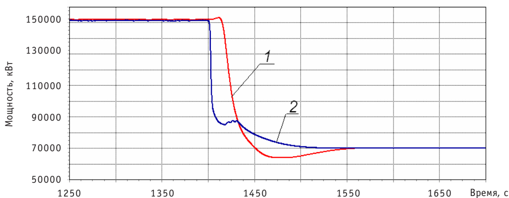
Рис. 4. График изменения мощности: 1 – мощность, выделяемая в активной зоне; 2 – мощность, снимаемая в парогенераторах
