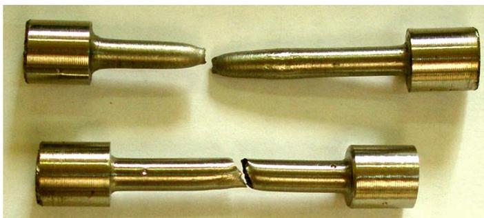
Рис. 7. Внешний вид образцов после испытаний: верхний образец вырезан из трубы с применением ультразвуковой обработки, нижний – из трубы, сваренной по штатной технологии, без ультразвуковой обработки
