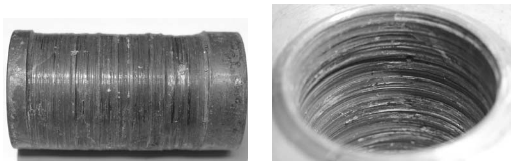
Рис. 3. Фотографии наружной поверхности втулки вала и внутренней поверхности втулки подшипника после 950 ч работы в среде свинца при T = 480\text{--}510^\circ\text{C}
