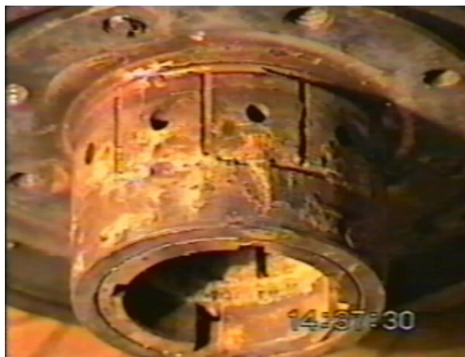
Рис. 1. Погружная часть насоса станда ФТ-1 (дросселирующие отверстия гидростатического подшипника)
