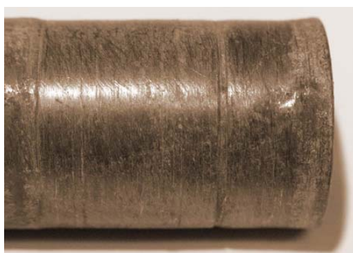
Рис. 5. Фотографии поверхностей втулки вала и втулки подшипника насоса НЦС-01 после испытаний
