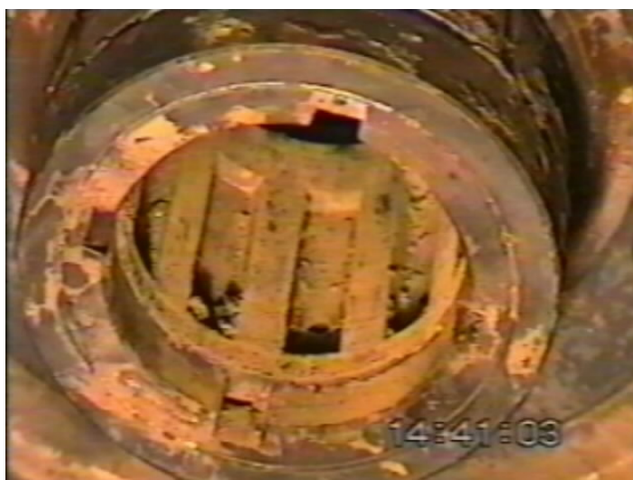
Рис. 2. Погружная часть насоса станда ФТ-1 (рабочая поверхность гидростатического подшипника и напорные камеры)
