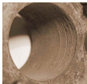
Рис. 5. Фотографии поверхностей втулки вала и втулки подшипника насоса НЦС-01 после испытаний
