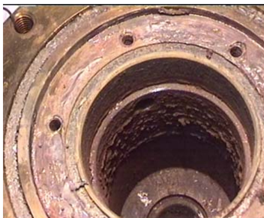
Рис. 4. Конструктивная схема насоса НЦС-01 и вид бака насоса после испытаний
