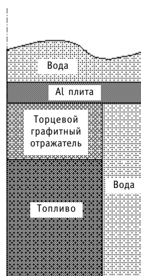
Рис. 1. Схема модели топливной ячейки реактора TRIGA (одна четвертая часть симметрии)
