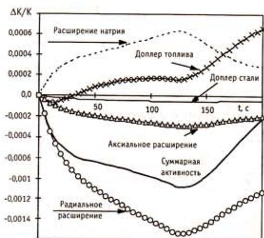
Рис. 8. Типичный баланс реактивности в аварии типа ULOF для большого реактора с объемной долей топлива 62% (традиционная компоновка)
