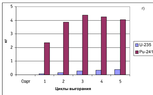
Рис 4. а) отношения концентраций после циклов выгорания к стартовому значению; б,в,г) массы основных нуклидов на одну ТВС
