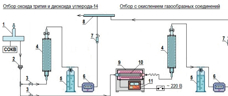
Рис. 1. Схема системы отбора проб ^3\text{H} и ^{14}\text{C} из вентиляционного воздуха: 1 – линия отбора газа из галереи высотной трубы; 2 – фильтр аэрозольный; 3 – вентиль; 4 – адсорбер-пробоотборник; 5 – барботер со щелочью; 6 – счетчик газовый; 7 – ротаметр регулировочный; 8 – вакуумная линия; 9 – печь электрическая трубчатая; 10 – колонка окислительная – катализатор; 11 – регулятор температуры
