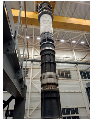
Рис. 6. Опытный образец ГЦНА РУ БРЕСТ-ОД-300 при промежуточном извлечении в процессе ресурсных испытаний
