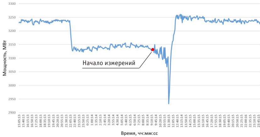
Рис. 2. Изменение мощности реактора при выполнении измерений ПКР. Измерения выполняют через 11 часов после снижения мощности
