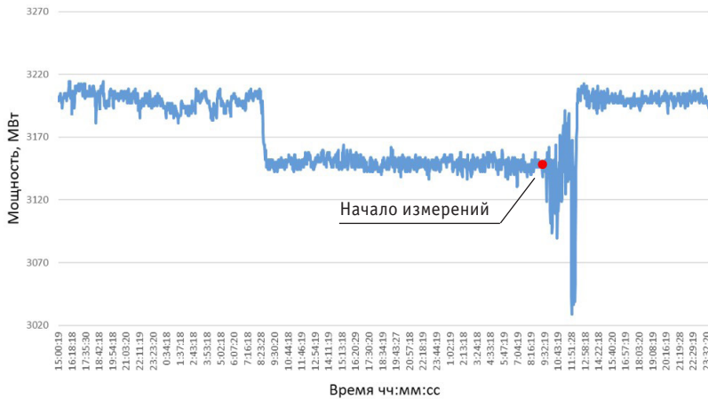
Рис. 3. Изменение мощности реактора при выполнении измерений ПКР. Измерения выполняют через 25 часов после снижения мощности
