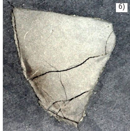
Рис. 8. Вид рабочих спектрограмм (относительная погрешность 5%) образцов обогащенного V_2C для расчета выгорания изотопа ^{10}V (а) и радиальный фрагмент вкладыша (б) из зоны пэла с максимальным выгоранием
