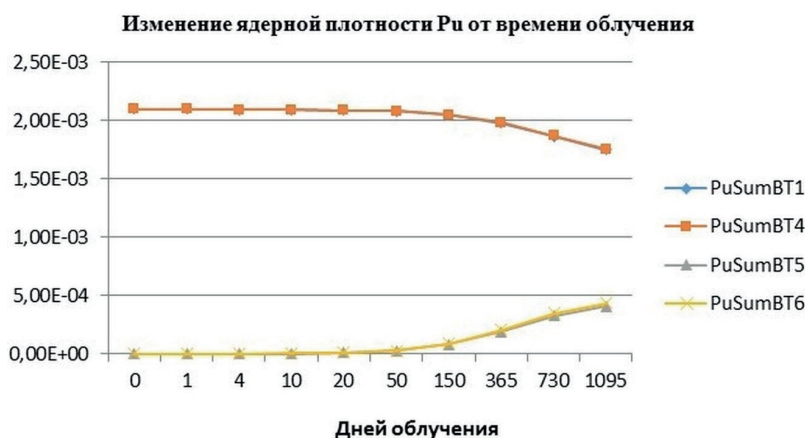
Рис. 5. Изменение в зависимости от времени концентраций Рu в вариантах ВТ1, ВТ4 – ВТ6, использующих в качестве МОКС-топлива (ВТ1, ВТ4) или уран (ВТ5, ВТ6)
