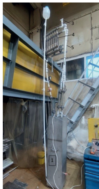
Рис. 5. Экспериментальный стенд системы пассивного отвода тепла от шахты-хранилища: 1 – бак с водой и термосифоном; 2 – дыхательная емкость; 3 – воздушник; 4 – конденсатор; 5 – соединительные трубы
