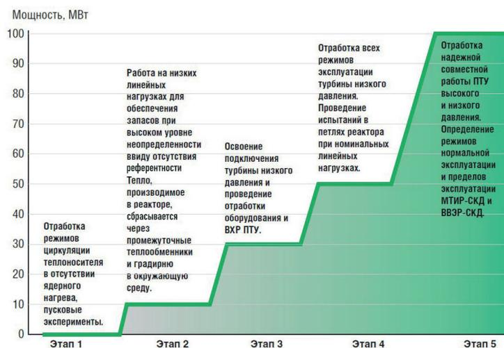
Рис. 4. Поэтапное освоение мощности реактора МТИР-СКД
