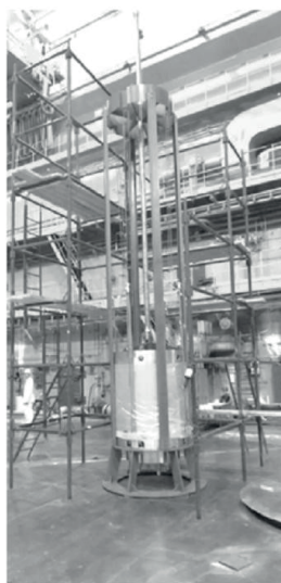
Рис. 8. Стенд для подготовки центральной зоны к монтажу: 1 – ступень; 2 – центральная зона; 3 – траверса; 4 – каркас; 5 – трубки КГО
