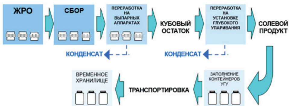
Рис. 2. Схема обращения с ЖРО на ААЭС
