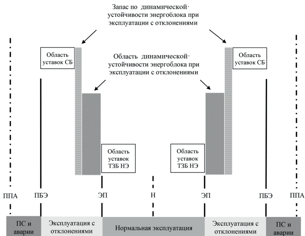
Рис. 1. Шкала проектных пределов: Н – номинальный режим; ТЗБ НЭ – технологические защиты и блокировки в области нормальной эксплуатации; ЭП – эксплуатационные пределы; СБ – системы безопасности; ПБЭ – пределы безопасной эксплуатации; ПС – предаварийные ситуации; ППА – проектные пределы для аварий
