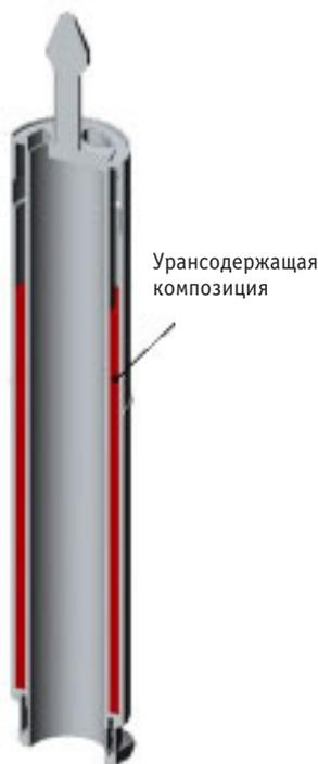
Рис. 1. Конструкция мишени с проточным охлаждением для производства  $^{99}\text{Mo}$
