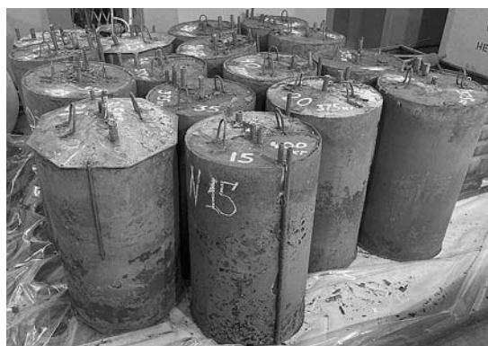
Рис. 6. Реакционные ёмкости с переработанным натрием первого контура (по 50 л) на модуле МАГМА-ТФО перед погрузкой в контейнеры НЗК-150-1,5
