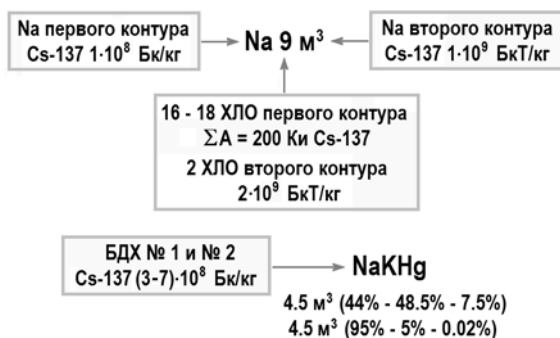
Рис. 3. Состав отходов щелочных теплоносителей на ИР БР-10
