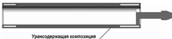
Рис. 3. Схема блок-контейнера для наработки ^{99}\text{Mo} (повёрнута на 90^\circ )
