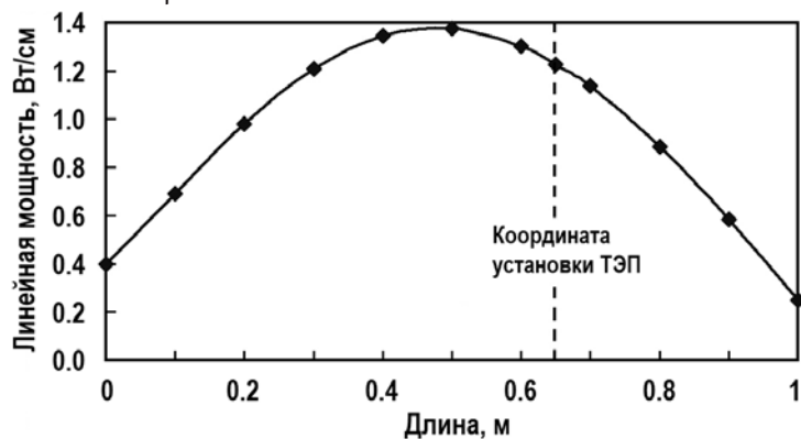
Рис. 2. Распределение линейной мощности по высоте активной части
