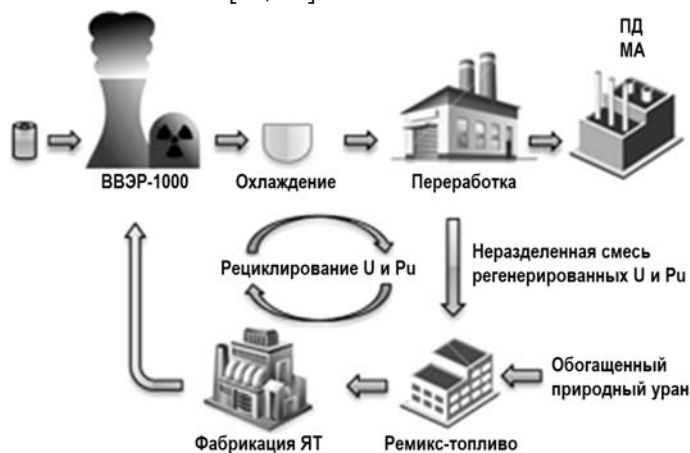
Рис. 1. Принципиальная схема рецикла РЕМИКС-топлива
