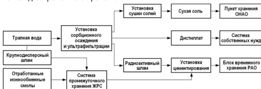
Рис. 3. Принципиальная схема обращения с ЖРО в основных зданиях УЗА и УКС блока № 1 НВАЭС-2
