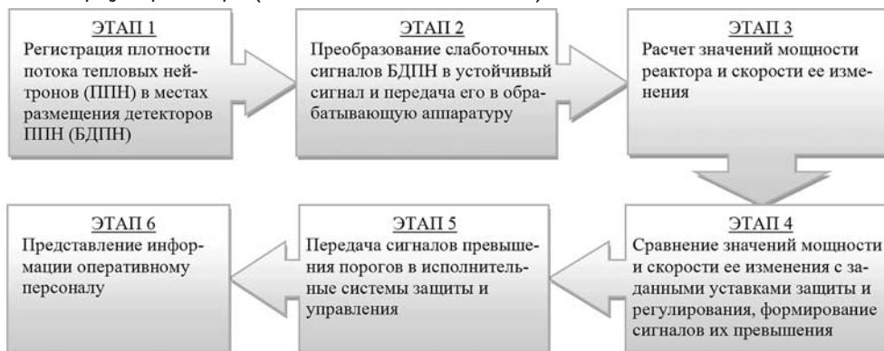
Рис. 1. Иллюстрация принципа функционирования канала АКНП
