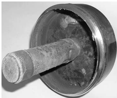
Рис. 1. Фильтр после эксперимента: общее количество отложений – 6,2 г, в том числе на дне фильтра – 5,2 г, на сетке фильтра – 1 г
