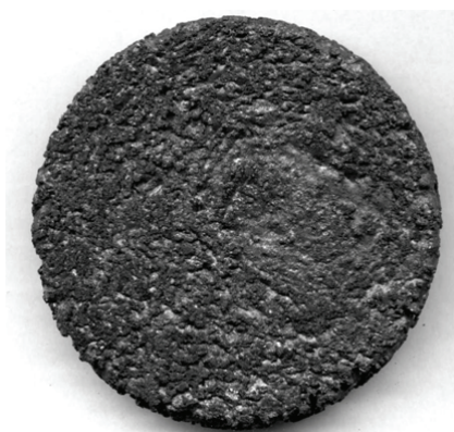
Рис. 2. СВС-продукт (диаметр 55 мм, толщина 7 мм)
