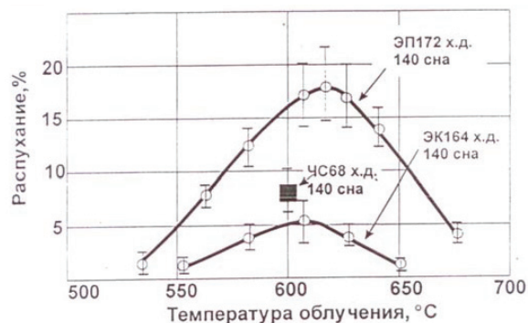
Рис. 4. Температурная зависимость распухания оболочечных труб в х.д. состоянии из сталей ЭК164, ЭП172-У [10], ЧС68 при облучении ионами хрома
