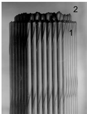
Рис. 4. Пучок твэлов с оболочками из сталей ЭП-450 (1) и ЧС-68 х.д. (2)
