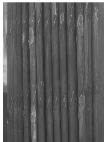
Рис. 5. Внешний вид оболочек из стали ЭП-450 после 10-летнего пенального хранения
