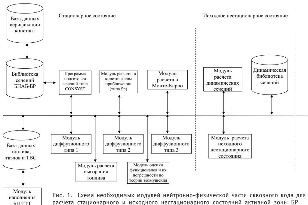
Рис. 1. Схема необходимых модулей нейтронно-физической части сквозного кода для расчета стационарного и исходного нестационарного состояний активной зоны БР
